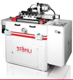
La gamme de machines CLM 150 – 500 est utilisée pour le rodage et polissage cylindrique de pièces sans points-centre. Pièce unitaire ou de moyenne série, courtes ou de plus grande longueur et ceci entre deux rouleaux à rotation parallèles:
